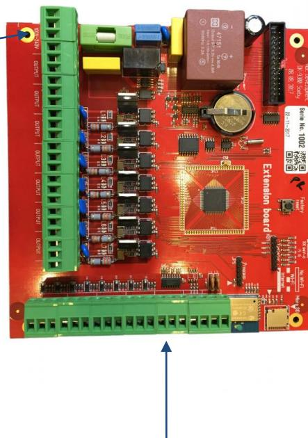
GND (sort ledning forbinder til GND på V16 printet.
