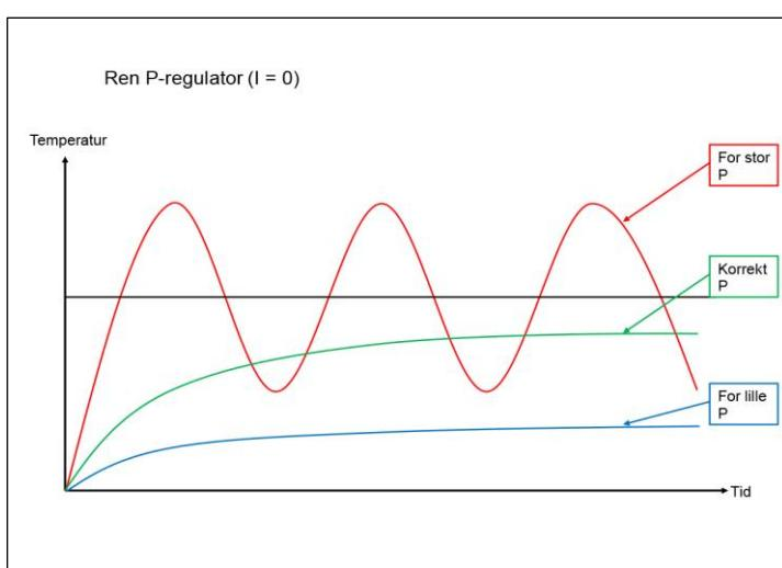
Ideen er så at I-leddet skal have den størrelse der netop er nødvendig for at opretholde den korrekte temperatur, og stille og roligt tilpasse sig til ændrede forhold (vekslende varmebehov). P-leddet skal reagere hurtigt når der er uoverensstemmelser mellem setpunkt og aktuel værdi, og sørge for at justere effekten op/ned mens I-leddet stille og roligt kommer på plads igen.
