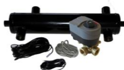
Kit: Vejrkompenings kit: SKU: 510027, 510028 Hav en høj kedeltemperatur, og reguler husets fremløbstemperatur i forhold til udetemperatur.
